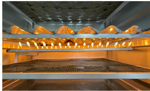
B. Proses pengeringan dengan adaptasi teknologi menggunakan oven hanya butuh waktu 4-5 jam.
